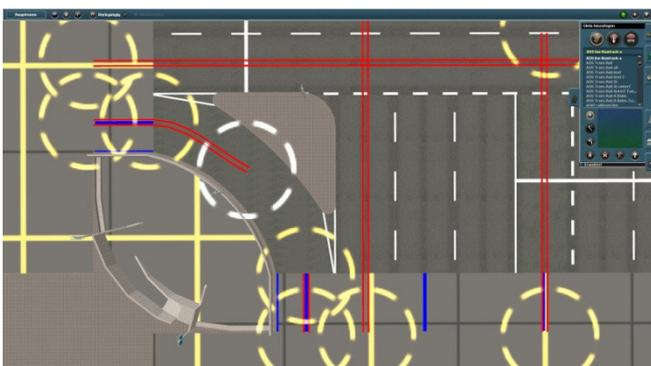
Wenn ein Track zwischen zwei in inneren von einer Kreuzung liegenden Punkten verlegt wird, setzen Sie immer einen Zwischenpunkt, erst dann verbinden Sie den Track mit dem Ziel. Anschließend kann der Zwischenpunkt gelöscht werden. Eine direkte Verbindung ist nicht möglich.
